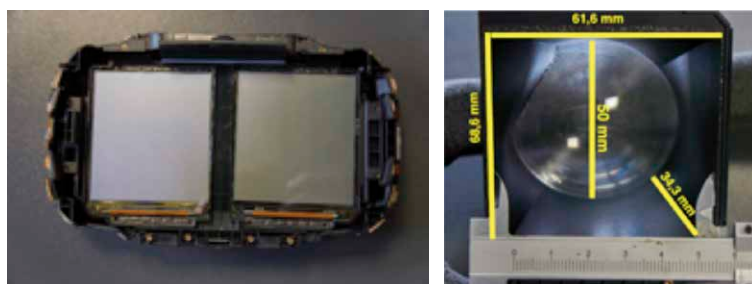
Bild 1 a/b. Geöffnetes Headset, Ausmaße der Linsen/Display-Halterung sowie des Linsendurchmessers (alle Bilder: die Autoren)
