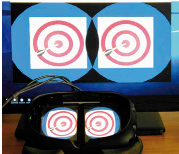
Bild 2. Vergleich zwischen der softwaregenerierten Bildvorschau und der vorverzerrten Präsentation auf den Displays
