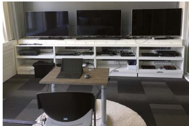
Abbildung 2: Hörversuchsaufbau in der IRT Wohnzimmerumgebung. Videowiedergabe erfolgte über den mittleren Bildschirm, Steuerung des Hörversuchs über das Laptop.
